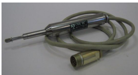
Рис. 4 Внешний вид преобразователя ЛИП-19А в исполнении 1
